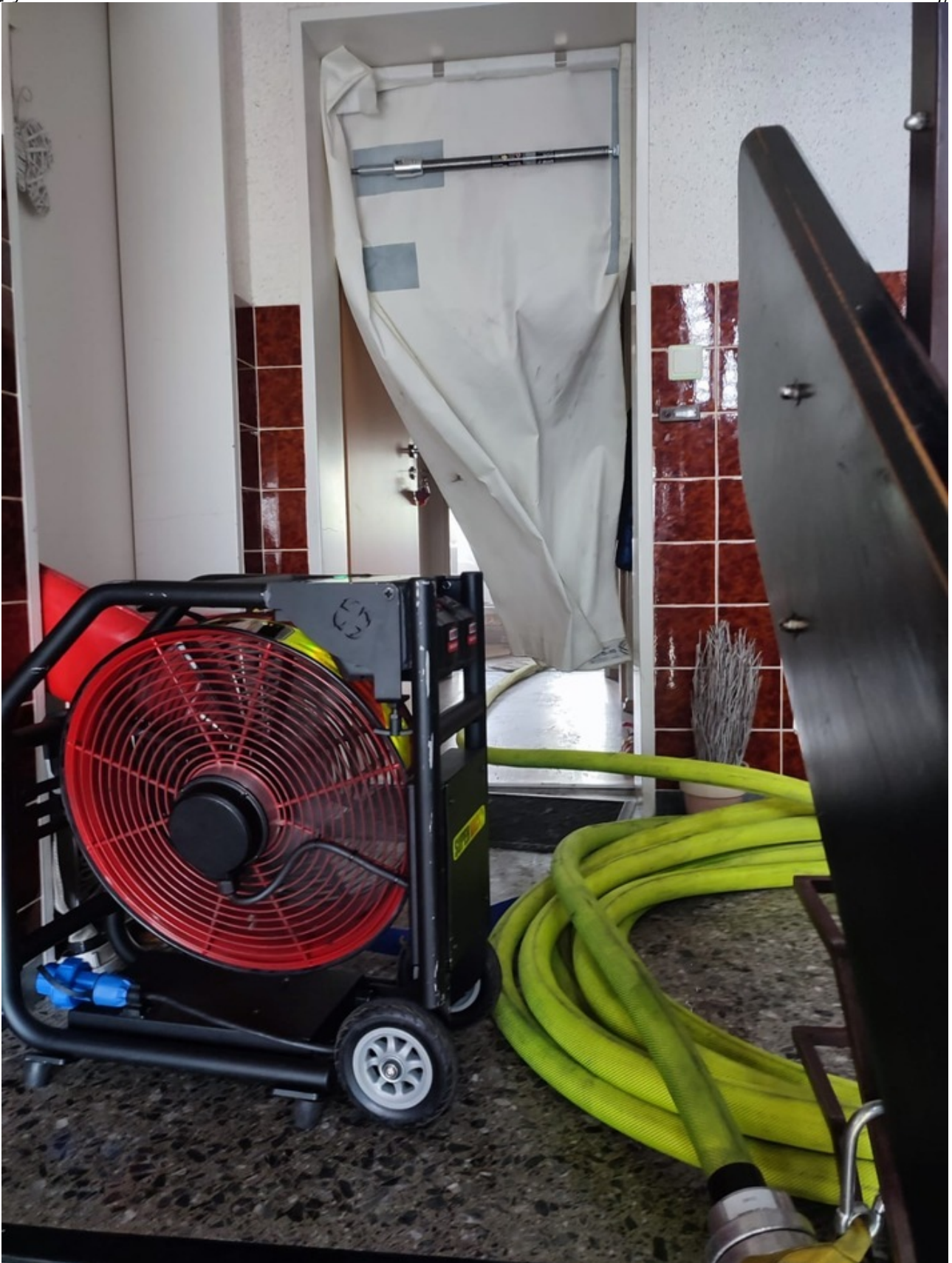
Rauchschürze im Eingangsbereich © Feuerwehr
