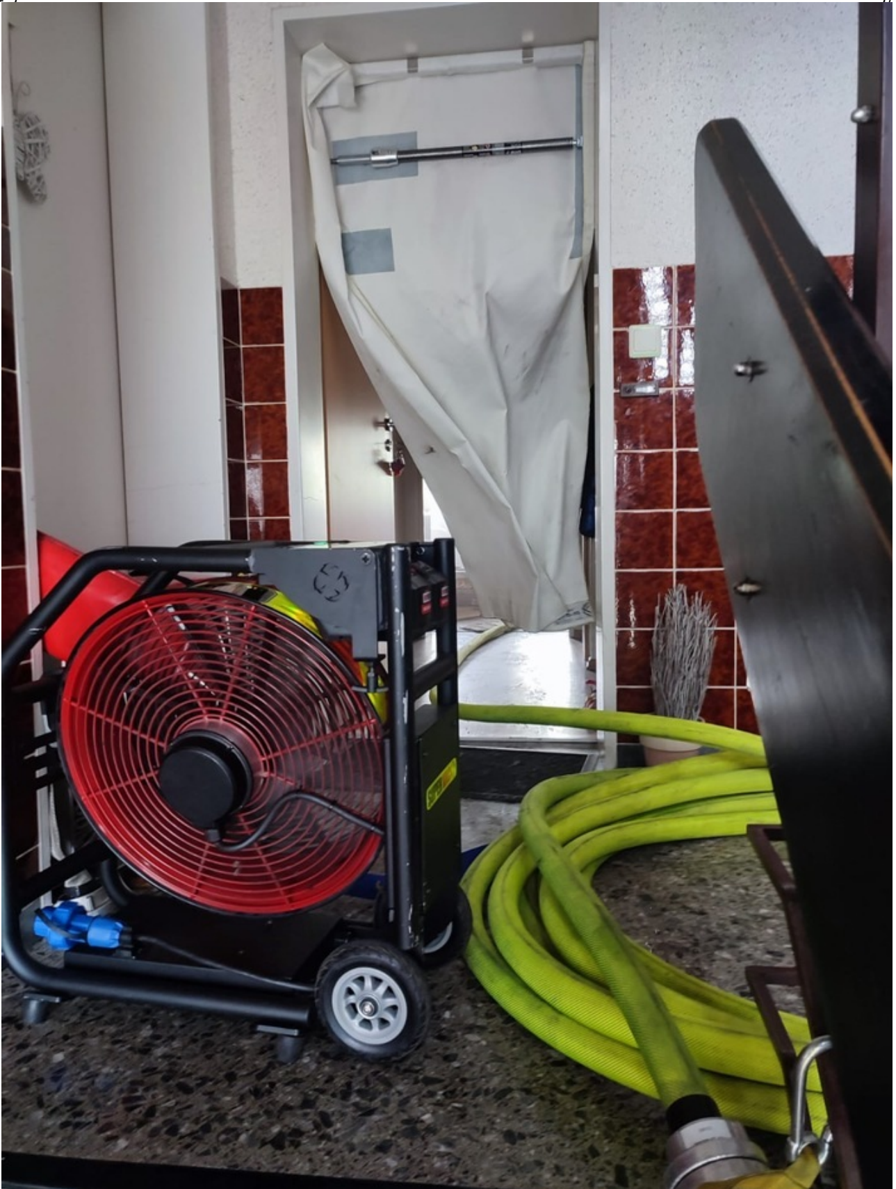
Rauchschürze im Eingangsbereich © Feuerwehr
