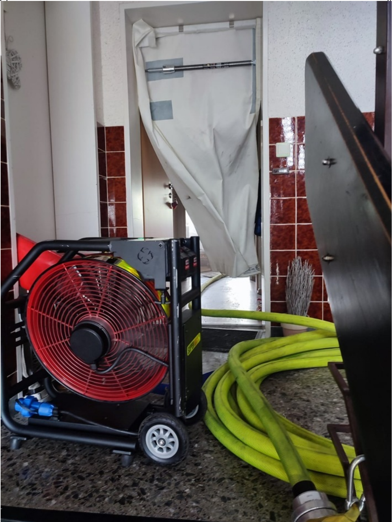
Rauchschürze im Eingangsbereich © Feuerwehr
