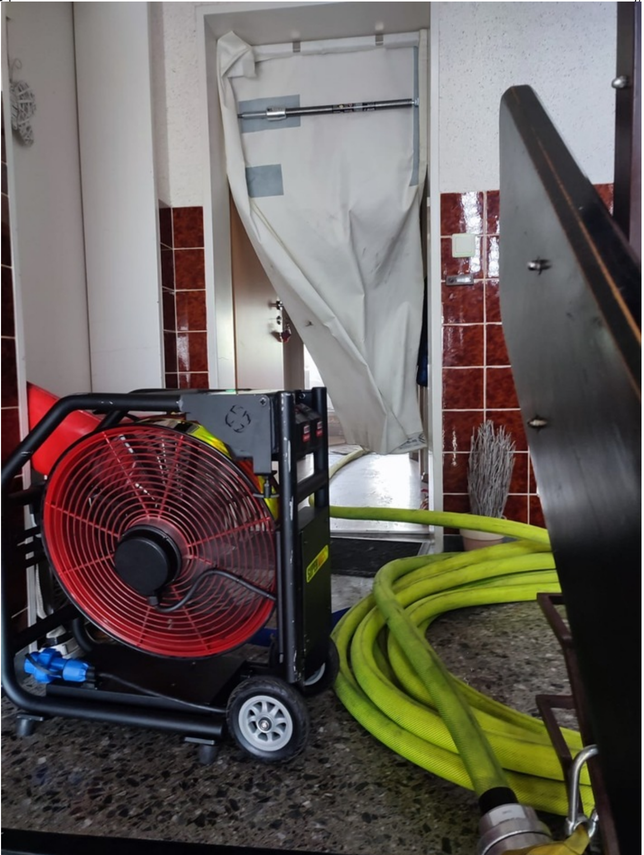
Rauchschürze im Eingangsbereich © Feuerwehr
