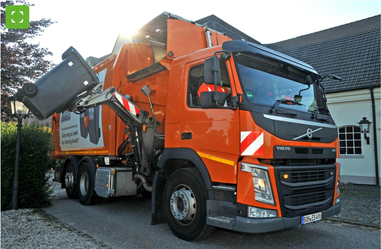
*Der ESB leert die meisten Müllgefäße mit einem Seitenladerfahrzeug. Der Greifarm erfasst eine Restmülltonne und leert diese oben in der Ladeöffnung aus. Der Fahrer auf dem Bild ist Maik van Drünen.*
